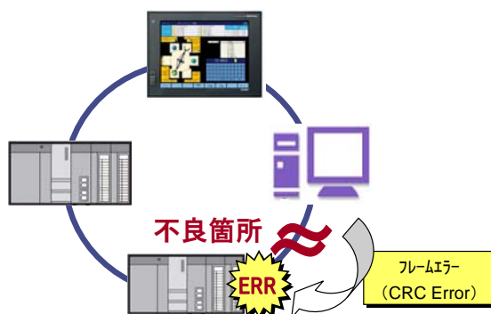
図7 ケーブル不良箇所の特定
